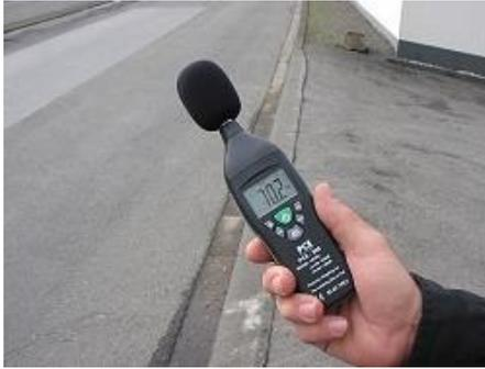
Para el levantamiento de datos se utilizó un decibelímetro RS-232/DATALOGGER marca EXTECH, modelo 407764. Este equipo toma lecturas de intensidades entre los 30 y 130 decibeles (dB), teniendo la capacidad de registrar en memoria, la máxima lectura de un intervalo de tiempo.
